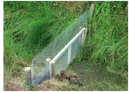
Abb. 1: Konstruktion der seitlichen Begrenzung des reaktiven Grabens
