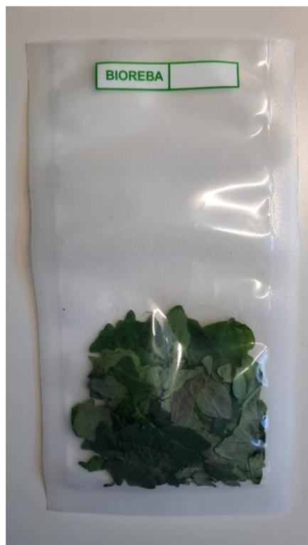
Abb. 1 Extraktionsbeutel mit maximaler Probenmenge
