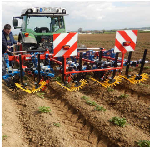
Bild 3 (oben): Für jeden Durchgang muss bei der Sternrollhacke der Winkel der Sternräder genau eingestellt werden, was zeitintensiv und sehr heikel ist
