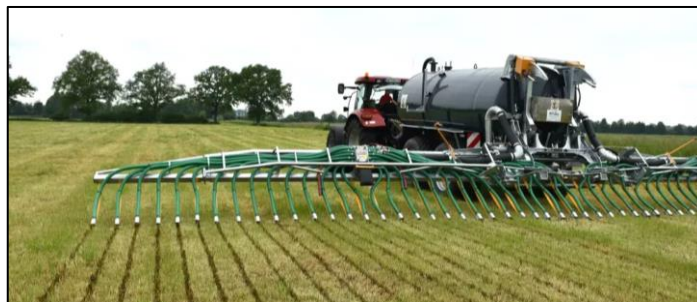
Streifenförmige Gülleausbringung (Bildquelle: top agrar online)
