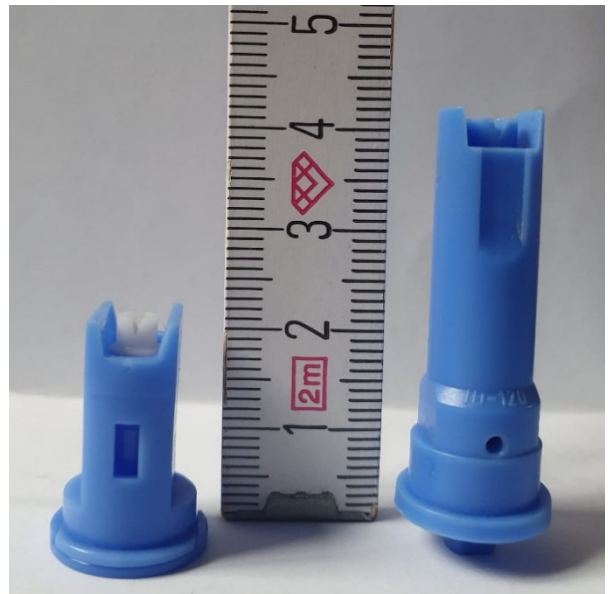
Abbildung 2: links: Kurze IDK Düse der Fa. Lechler. Opt. Spritzdruck 2 bar aufwärts; rechts: Lange ID Düse der Fa. Lechler. Opt. Spritzdruck 4 bar aufwärts
